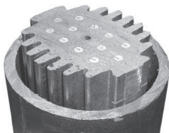
Рис. 1. Испаритель Torrexh в разрезе
