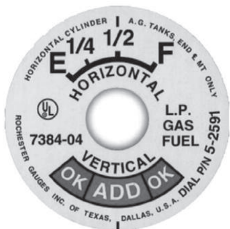
Рис. 9.1. Шкала поплавкового уровнемера
