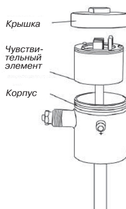
Рис. 3. Демонтаж чувствительного элемента
